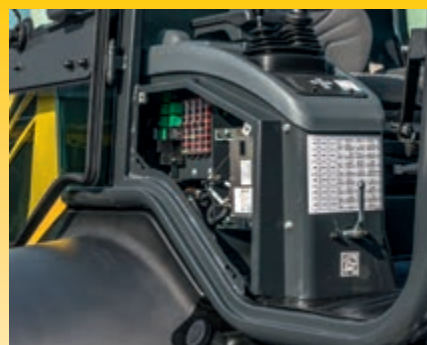
Zijpaneel voor snelle onderhoudstoegang
