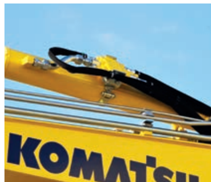
Slangbreukbeveiliging op hef- en armcilinders
